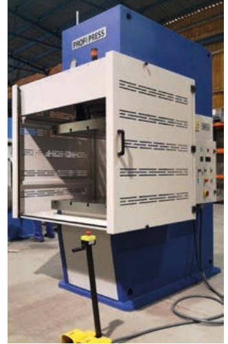
C-frame Press (200 Tn) for Hydroforming C-Rahmen Presse (200 Tn) für Hydroforming Presse à col de cygne (200 Tn) pour Hydroformage Prensa con cuello de cisne (200 Tn) para Hidroconformación
